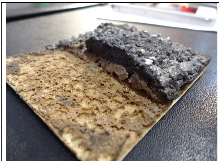
Слой пены, образованный путем воздействия пламени на покрытие RE-FLAME™ толщиной 0,4мм.
